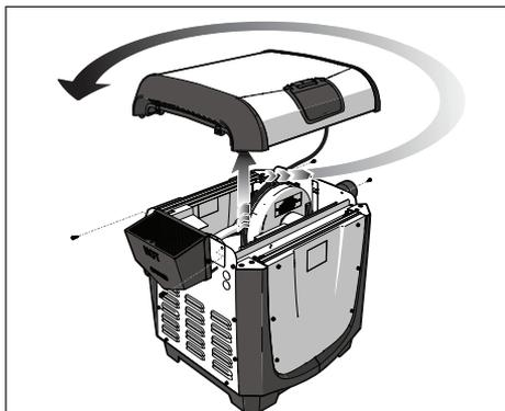
**REMARQUE :** Maintenir un dégagement pour l'entretien 12 po aux É.-U. Et 24 po au CAN à l'arrière de l'appareil de chauffage lors renversé.
